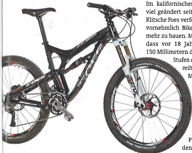
Dicke Schweißnähte und massives Alu verleihen dem Shaver-Rahmen einen Hauch von Prototypen-Style.
